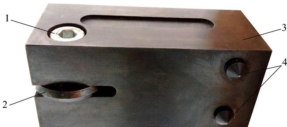
1 – винт фиксации индентора; 2 – индентор; 3 – корпус; 4 – заостренные ножки.
